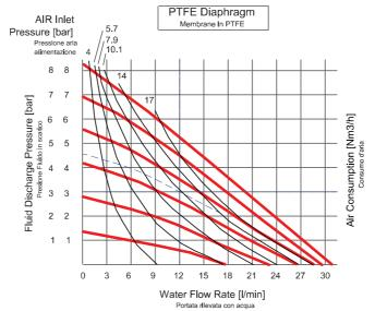
Per pompare 12 l/min ad una pressione di 3 bar, si richiedono di 4.6 bar di alimentazione con consumo d'aria di 14 Nm3/l
